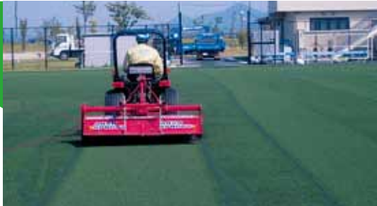
「かきおこし太郎」で人工芝を掻き解かし、ゴミ等の不純物を表面に出させる
